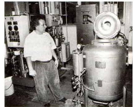
Abb. 5: HT-Musterfärbeapparat Thies für 5 – 10 kg (Foto: A. Barthold).
